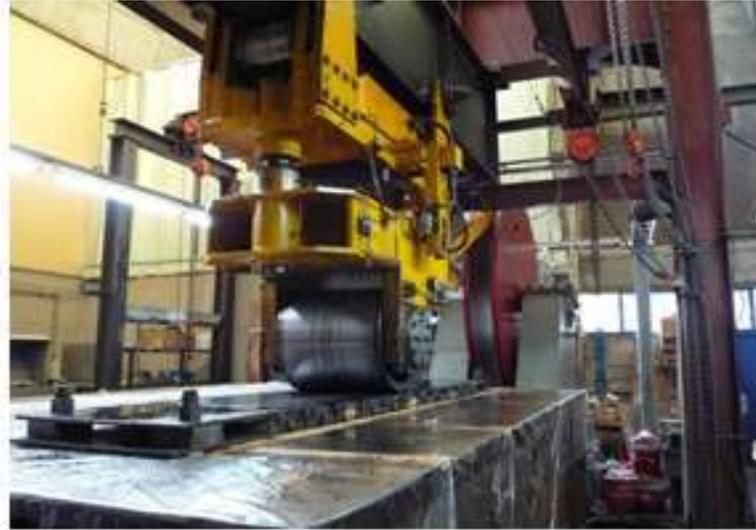
(a) 輪荷重走行試験状況
