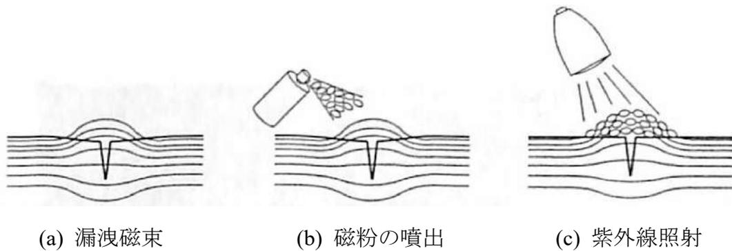
図 1.18 磁粉探傷試験
