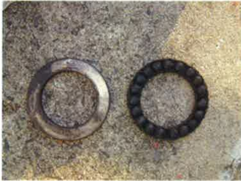
写真-8 ベアリングの腐食状態
