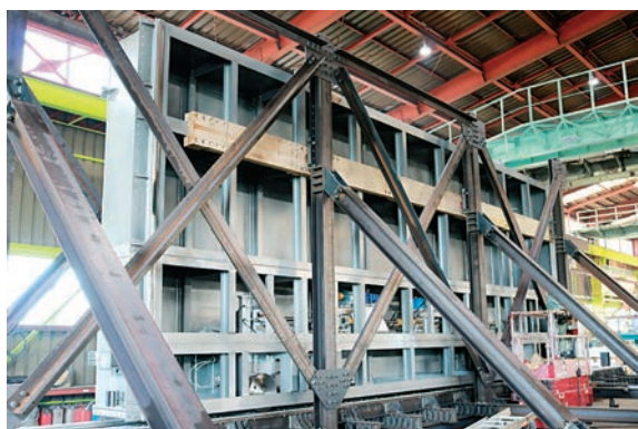
須賀12号陸間の走行実験(丸島アクアシステム様とJVで施工)
