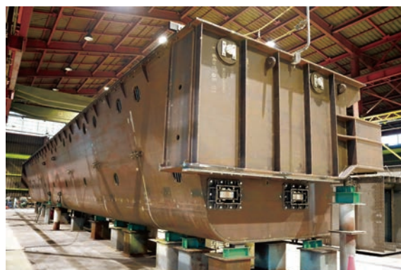
製作中の岩手県小鏡川水門(丸島アクアシステム様とJVで施工)
