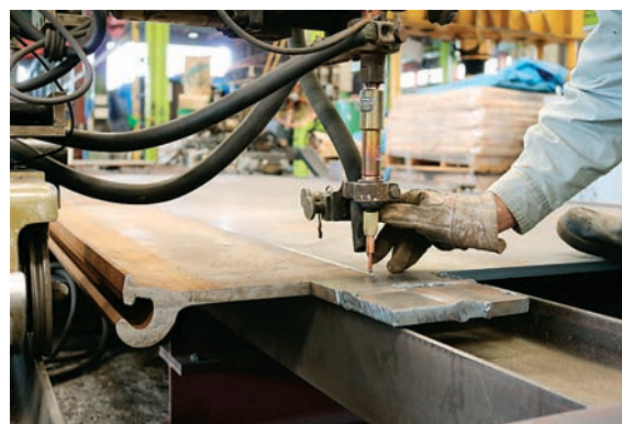
JESエレメントの製作状況(サブマージアーク溶接)
