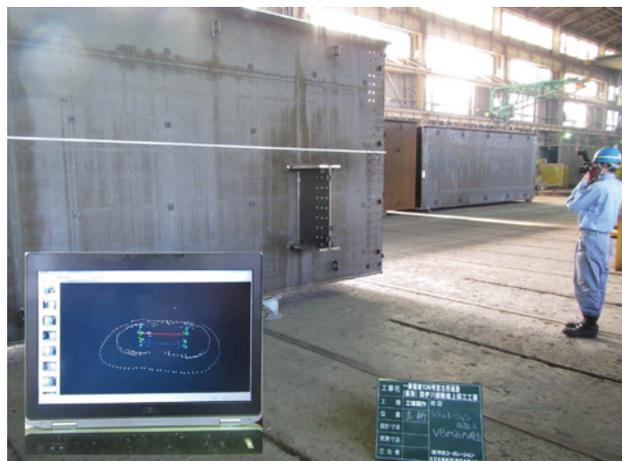
写真-2 シミュレーションによる仮組立
