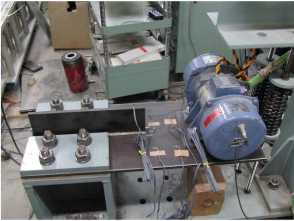
図-4 振動疲労試験機の写真
