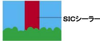
SICシーラーは当初、金属溶射用の封孔剤として開発しましたが、その特性である微細孔への浸透・硬化、基材への強付着力、及び無機系ポリマーの特徴である高耐候性等を活かし、多くの分野で活用しています。
