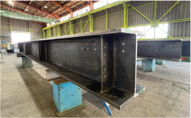
日光線 武子川橋りょう／ 197 [元請／ユニオン建設(株)] 東日本旅客鉄道(株) 栃木県 単純下路H型鋼工事桁 L 13.71m 1連 25.985t
