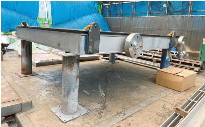
第二発電所水槽ゲート／148 東北農政局岩手山麓農業水利事業所 岩手県盛岡市 発電用ゲート（扉体、戸当り）ステンレス製ローラーゲート W 3m × H 4m 1門
