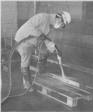
TERUI敷地内での説明会で、参加者はメーカーから装置の説明も受ける(写真上)。実際に素地調整を行う参加者(同下)
